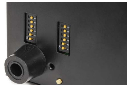
Po bardziej zaawansowane regulacje (obciążenia) trzeba sięgnąć na dolną ściankę, do mikroprzełączników.
